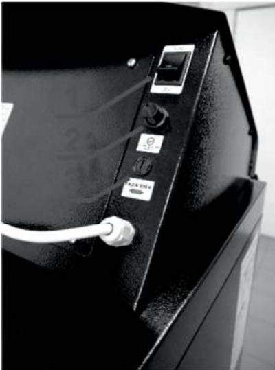
**Bild 17.** 1 – Hauptschalter, 2 – Havarie Thermostat, 3 – Sicherung (F6,3A)
