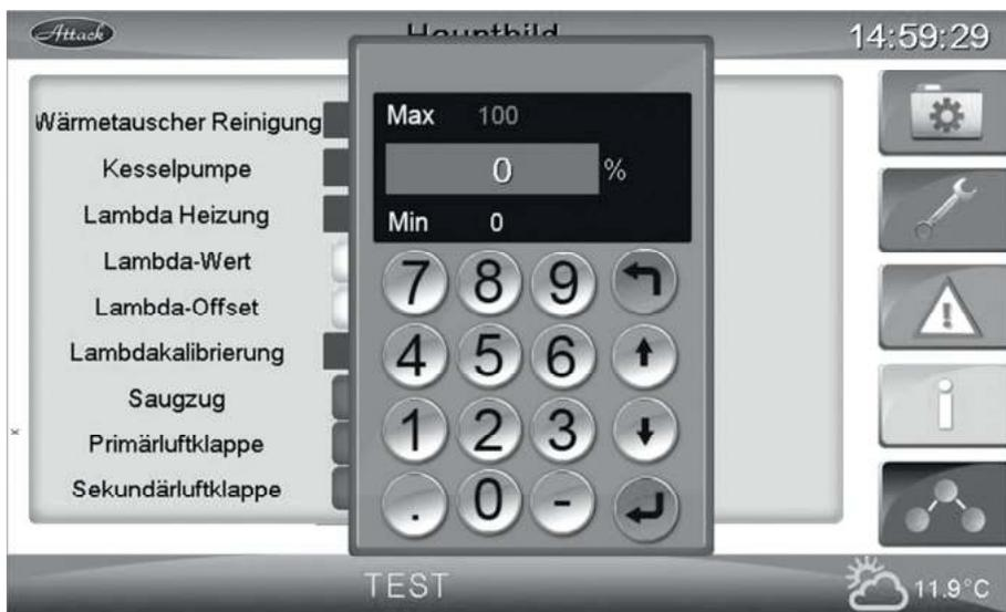
**Bild 23. Testaktivierung des modulierbaren Gerätes**
