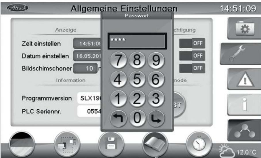
**Bild 53. Zugang zu erweiterte Parameter**
