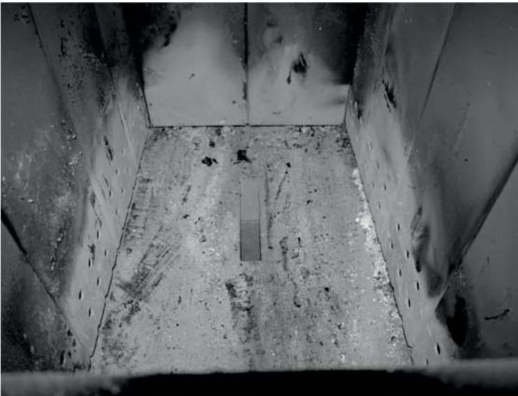
**Bild 6. Richtig gereinigte Ladungskammer**
