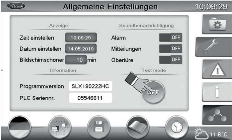
**Bild 24. Kesseltestmodus verlassen**
