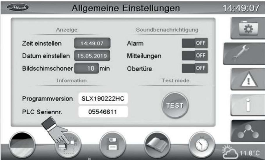
**Bild 42. Klick für das Anzeigen der Netzeinstellung**
